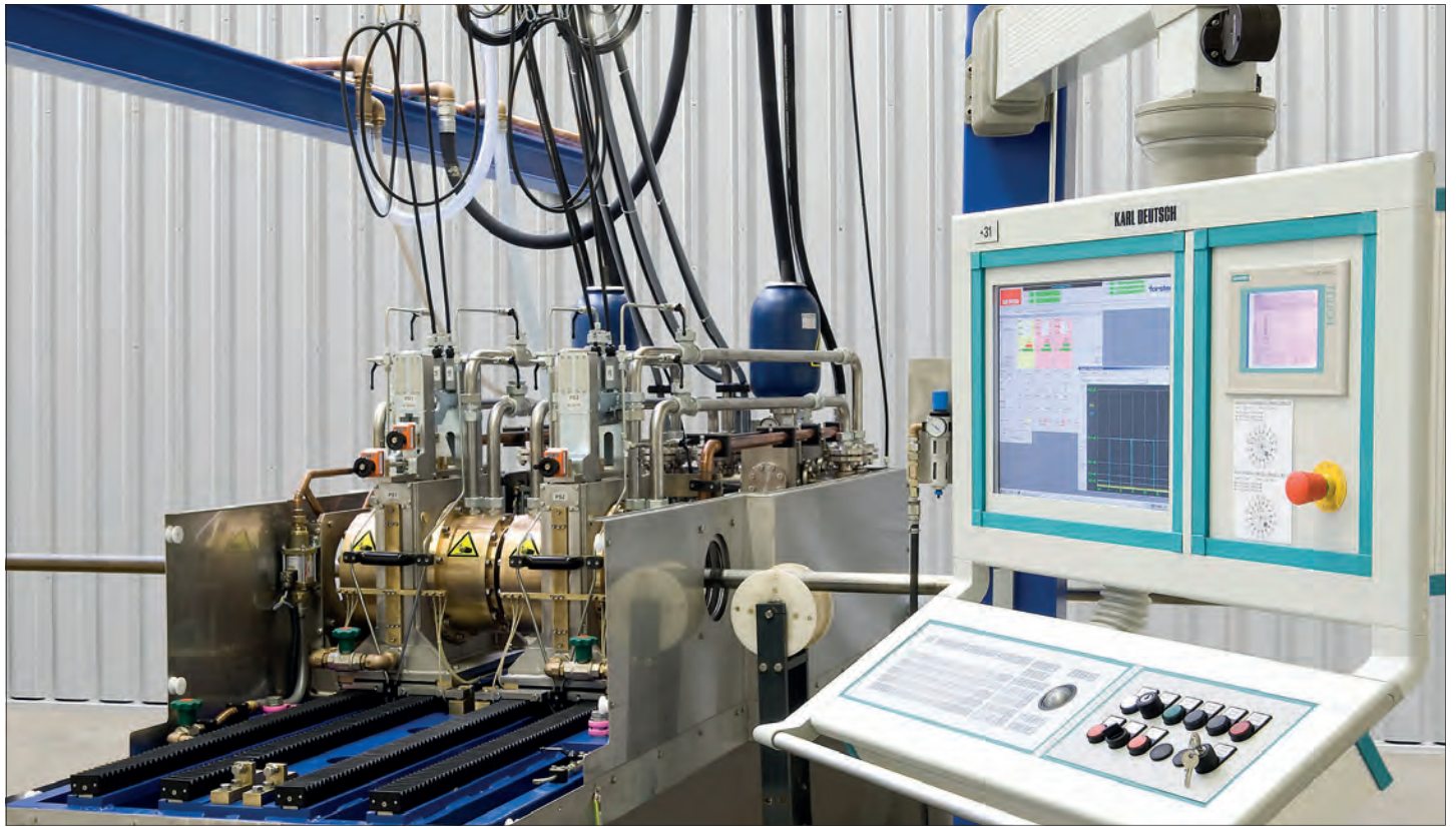
管道測試系統和操作面板可以調整超音波測試參數和西門子PLC參數。
